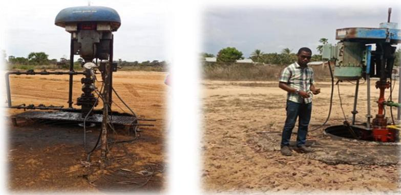
**Figure 1 :** (a) Fuites de brut du pétrole et (b) déversements de boue autour des puits d'extraction
