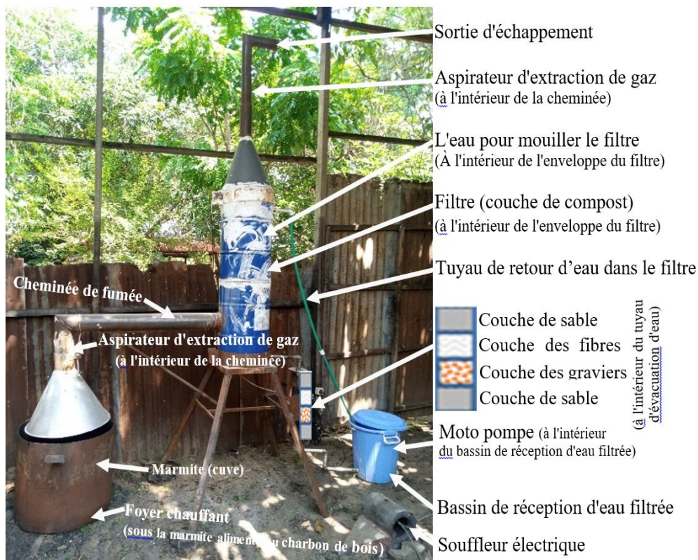
Figure 2. Présentation du dispositif filtrant fabriqué
