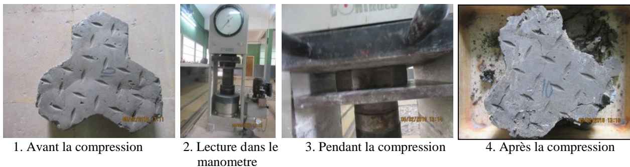
Figure 6. Illustration de la Réaction des pavés soumis au test de résistance
